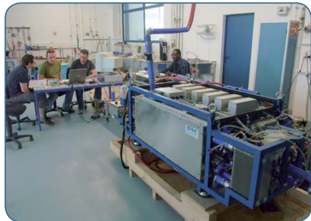
Das Zemships-Brennstoffzellenaggregat (PM Basic A 50 maritime) bei Proton Motor auf dem Prüfstand.
