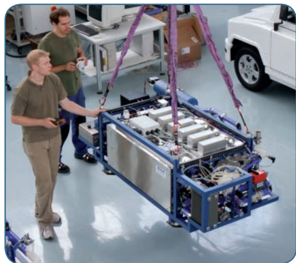
Das BZ-System der FCS „Alsterwasser“ wird nach der Wartung wieder verladen.
